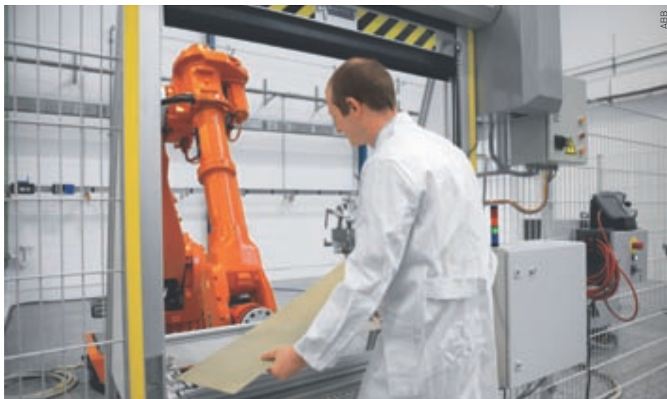
Zusammen statt durch Zäune getrennt: Mensch und Roboter können nun ohne Sicherheitsrisiko in unmittelbarer Nähe zueinander agieren und zusammenarbeiten.
