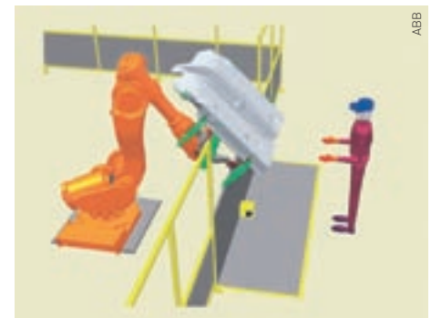
Leistungsstarke Softwaretools bieten Ingenieuren die Möglichkeit, die Sicherheitszonen in der Planungsphase in einer virtuellen Umgebung zu entwerfen und zu testen.
