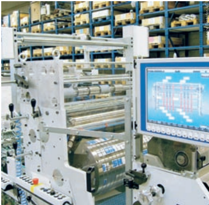
Zwei Rechnersysteme: Hardwareplattform für Motion-Runtime und Soft-SPS ist der Lenze-PC CPC 2700, die Visualisierung übernimmt die als Bedieneinheit genutzte Command Station CS 5750 von Lenze.
