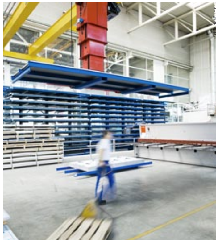
Ein Stapelkran erleichtert den Arbeitern des Metall- und Fassadenbauunternehmens Sottas SA das Stapeln von Blechen.
