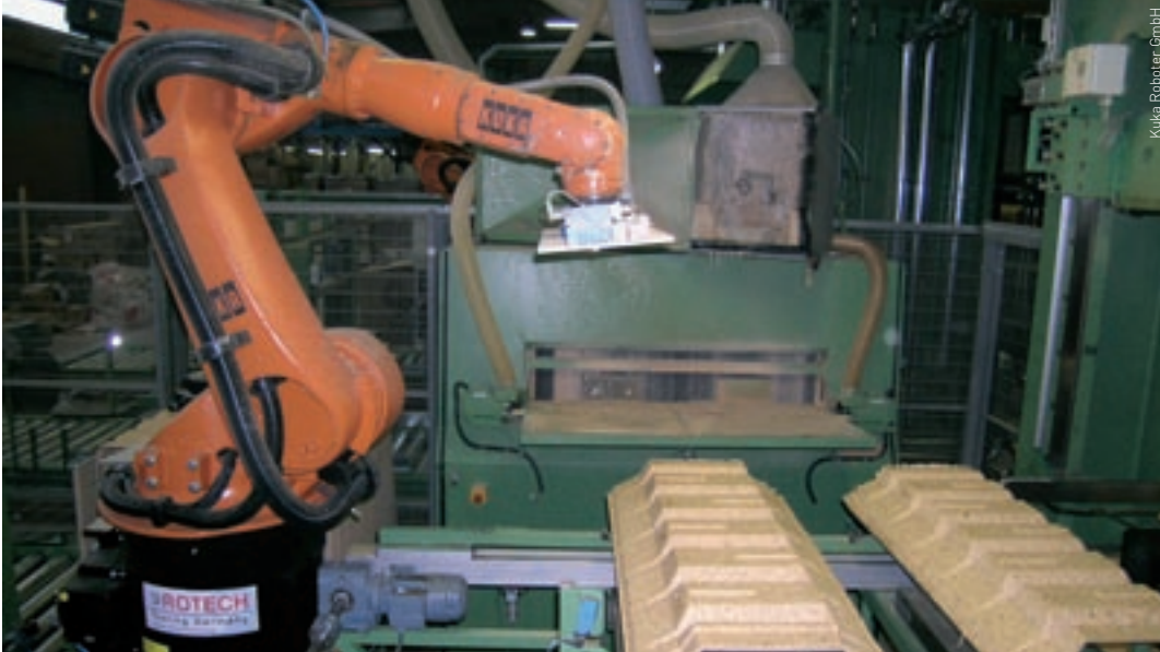
Drei Kuka-Roboter übernehmen bei der Werzalit AG + Co KG wichtige Aufgaben bei der Herstellung von Schalelementen.
