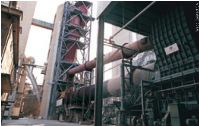
Der Drehrohrofen für die Klinkerherstellung dominiert das Firmengelände.
