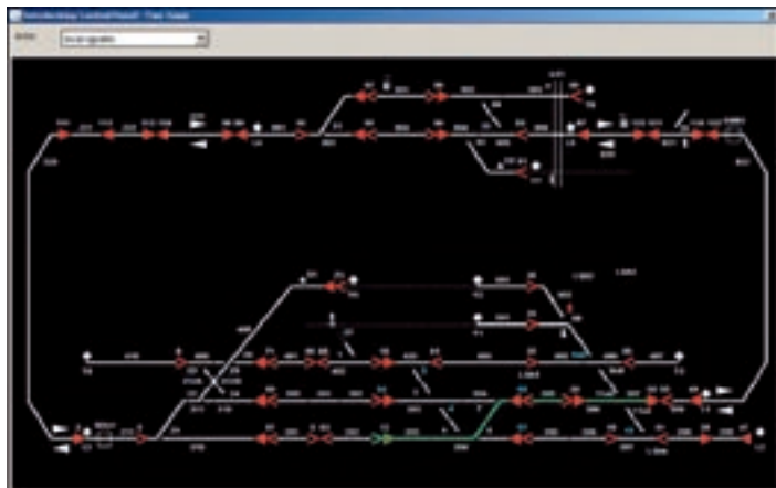
Ausführbare Spezifikation eines Stellwerksystems im Bahnbereich aus Benutzersicht.
