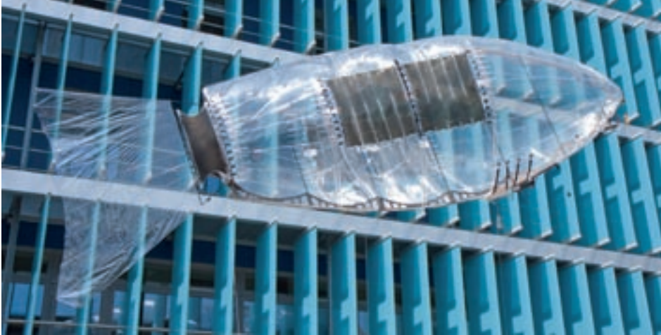
Das Empa-Luftschiff «Blimp» bewegt sich wie eine Forelle im Wasser: An der Hülle und den flossen befinden sich EAP-Aktuatoren.
