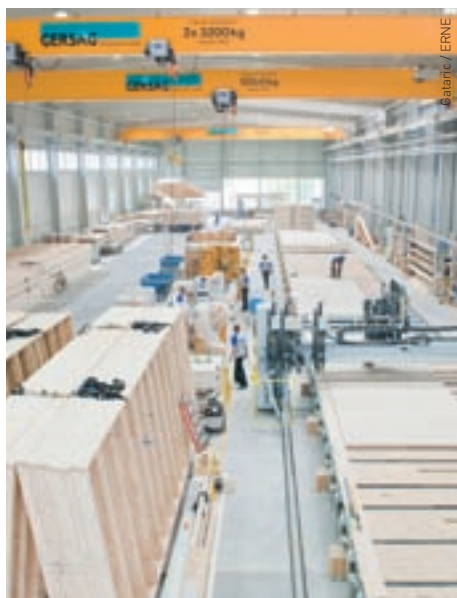
Die neue Produktionshalle der ERNE AG Holzbau mit dem neuen CNC gesteuerten Element-Fertigungs-Center. Das Fertigungs-Center besteht aus einer Multifunktionsbrücke mit einem Roboterarm und drei Montagetischen à 15 x 4 m Grösse. (Insgesamt 50 m Länge x 4 m Breite)
