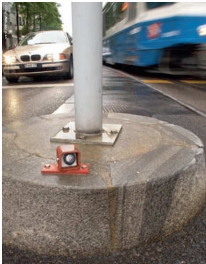
Mit den Tachymetern werden Prismen angezielt, die an den zu überwachenden Objekten befestigt sind. Hier ein Prisma mitten im Strassenverkehr an der Löwenstrasse.
