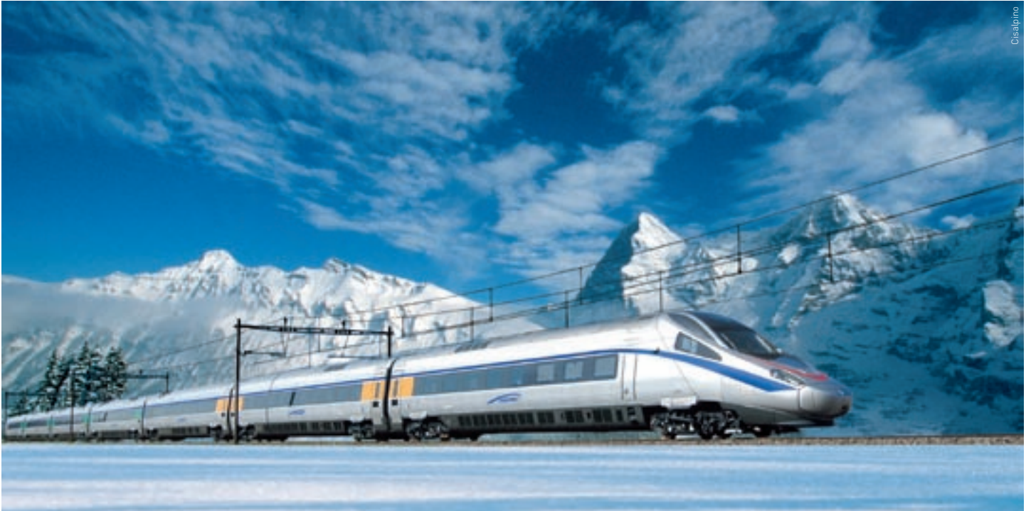
Der Cisalpino II ETR 610 mit der Knautschzone vorne an der Spitze des Zuges.
