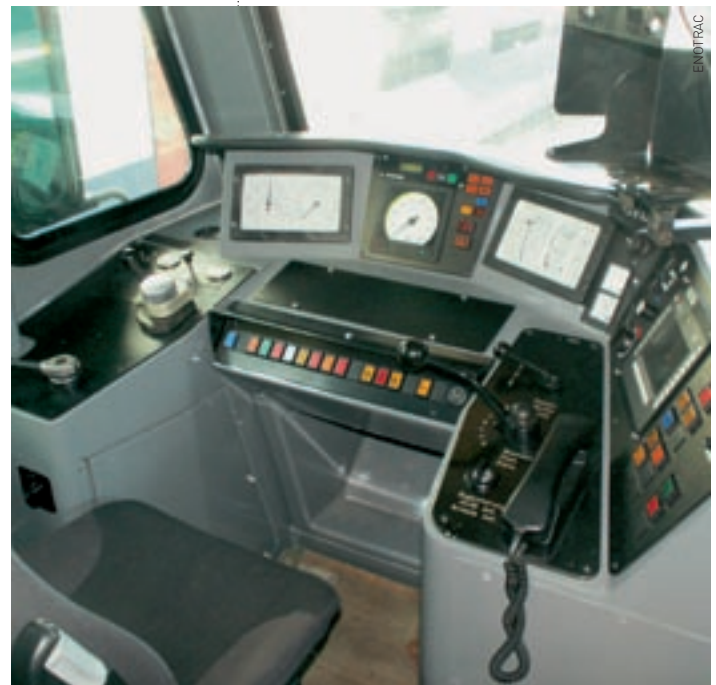
Vergleich altes (l) und neues (r) Führerpult. In der Mitte ist die neue Gestaltung durch den Ersatz des Steuerschaltkastens ersichtlich.
