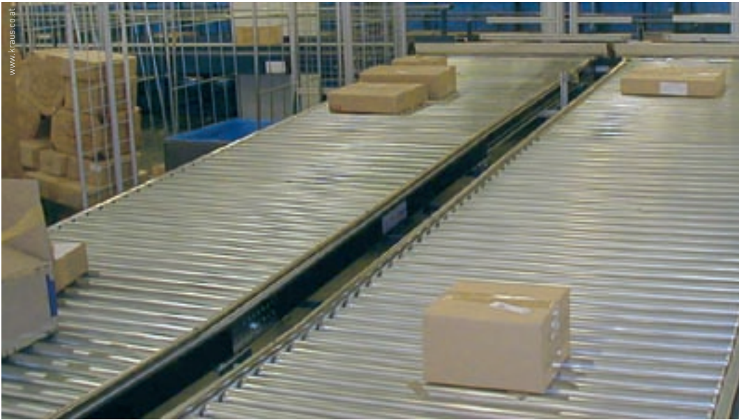
Wachsen elektrostatische Aufladungen durch Roll- und Gleitbewegungen zu stark an, so besteht die Gefahr von Funkenbildungen und Schäden an empfindlichen Produkten. Um dies zu vermeiden, müssen elektrostatische Aufladungen kontinuierlich abgeleitet werden.
