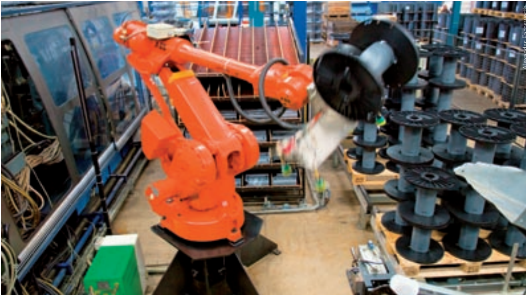
Ein Roboter vom Typ IRB 4400 bei Axjo in Schweden entnimmt Gussteile aus der Spritzgiessmaschine und montiert Kunststoffrollen.
