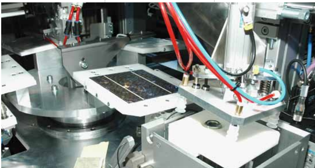
Test et triage de cellules solaires grâce à une machine de contrôle développée et fabriquée par TCI Engineering.
