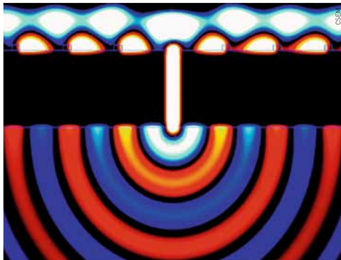
Simulation de la lumière passant à travers une minuscule fente d'un film métallique structuré à l'échelle nanométrique.
