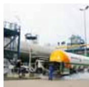
EN COUVERTURE Le CO 2 qui a été isolé dans les installations-pilotes de Schwarze Pumpe dans l'Etat de Brandebourg (Allemagne) sera ensuite transporté par camion jusqu'au lieu où il va être entreposé. Photo © : Vattenfall
