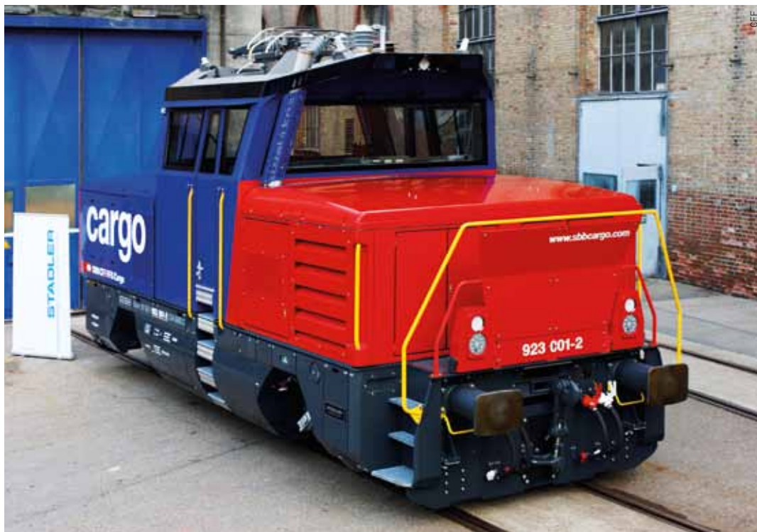
Un tableau de bord ultramoderne. Flexible, l'Eem 923 dispose d'une force de traction électrique deux fois plus puissante et d'un moteur diesel pour les voies de raccordement.
