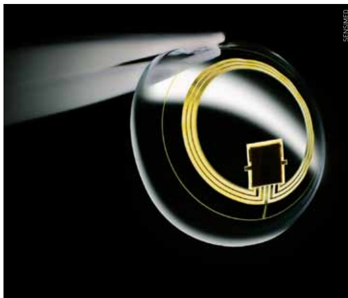
Un exemple significatif des possibilités de transfert des technologies du CeTT : ce système qui permet un monitoring en continu de la pression de l'œil pour détecter le glaucome, développé par SENSIMED Triggerfish en collaboration avec la HEIG-VD.
