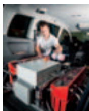
Die Empa entwickelte diesen Erdgashybrid in Zusammenarbeit mit VW. Im Bild die Lithiumionen-Batterie im Kofferraum. L'Empa a développé cet hybride au gaz naturel en collaboration avec VW. L'image montre la batterie lithium-ion dans le coffre. Fotograf: Christoph Kaminski
