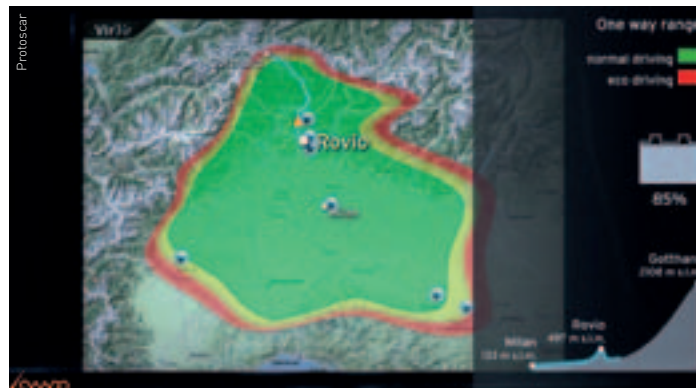
Als Resultat des VEL-Programms hat Protoscar zusammen mit VirVe ein System zur GPS-basierten Reichweitenschätzung entwickelt.
