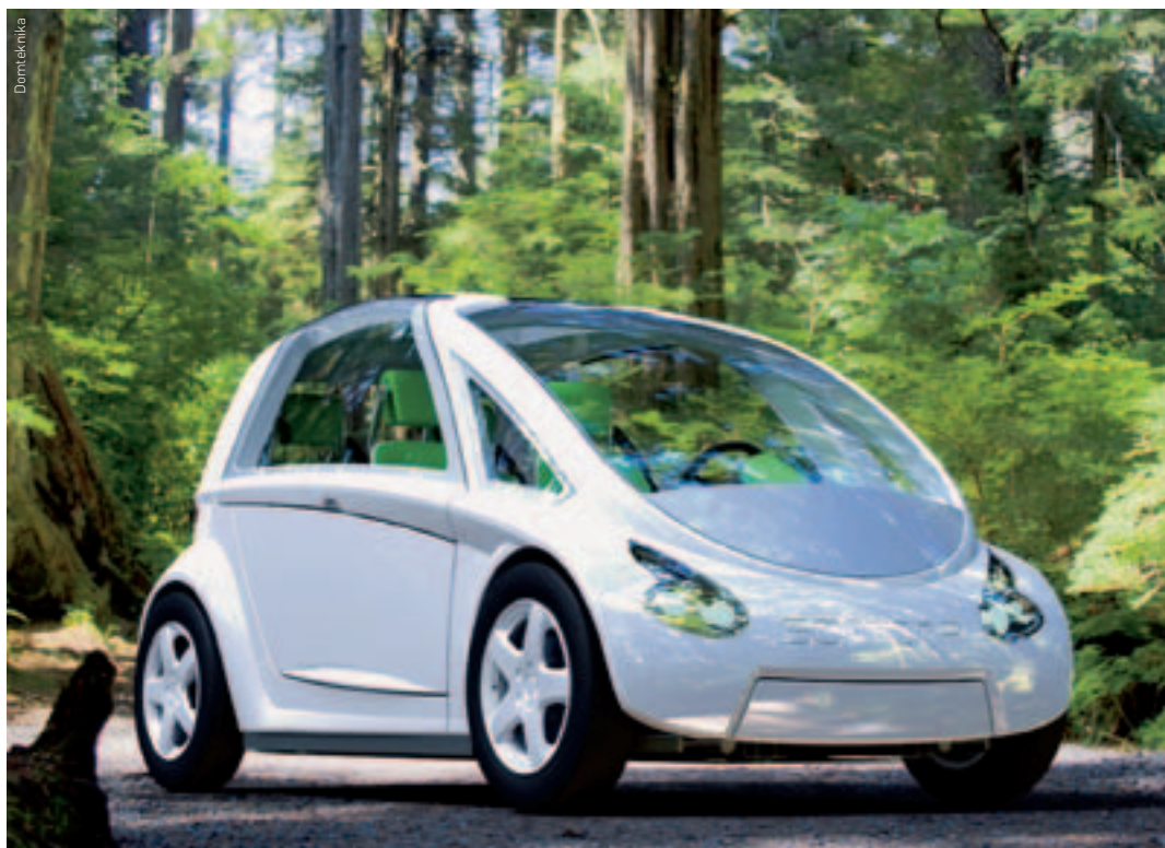
La Softcar : baptisée UPGO, elle sera construite avec une carrosserie en bio-polymères, jantes et pneus dans une matière spécialement adaptée (et protégée), ne pèsera que 400 kg et sera commercialisée à moins de 8'000 euros !
